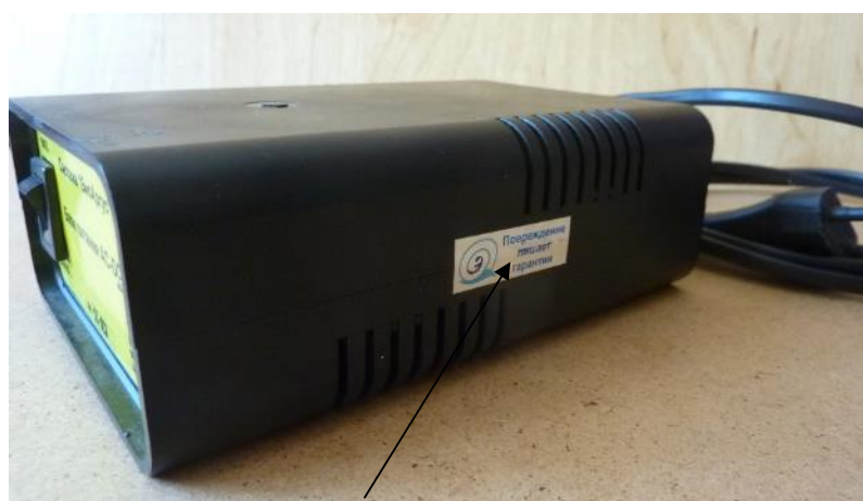
Рисунок 4 – Внешний вид блока питания (вид сбоку) и место его пломбирования от несанкционированного доступа
