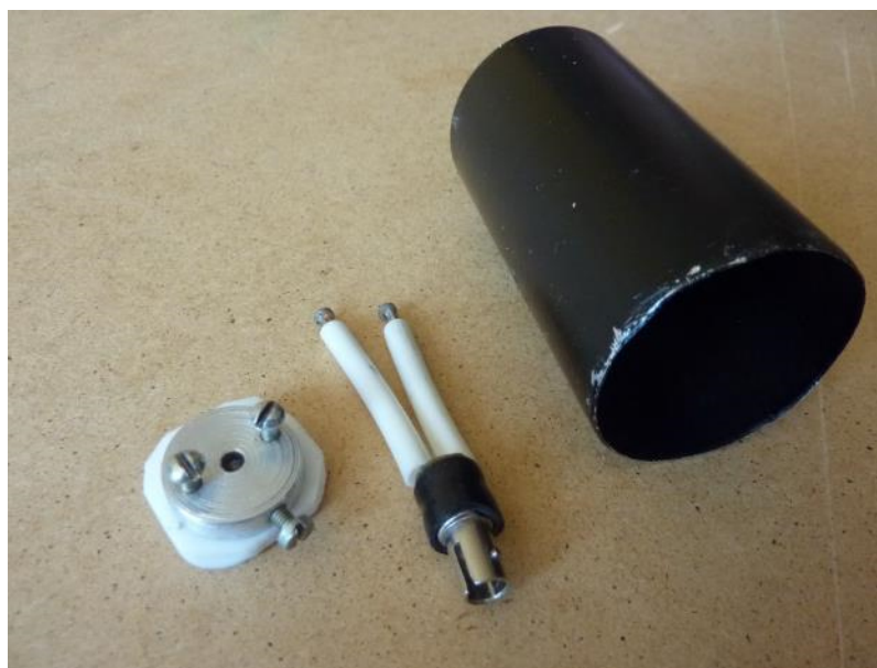
Рисунок 10 – Внешний вид УТК (слева), светозащитного стакана (справа) и фотодиода ФД 263-01 с установленным светоизолирующим экраном и съемным оптическим разъемом (в центре)
