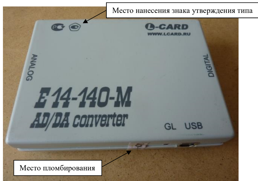
Рисунок 6 – Внешний вид АЦП E14-140 L-Card (вид сверху) и места пломбирования и нанесения знака утверждения типа
