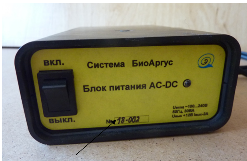
Рисунок 5 – Внешний вид блока питания (вид спереди) и место нанесения его заводского номера
