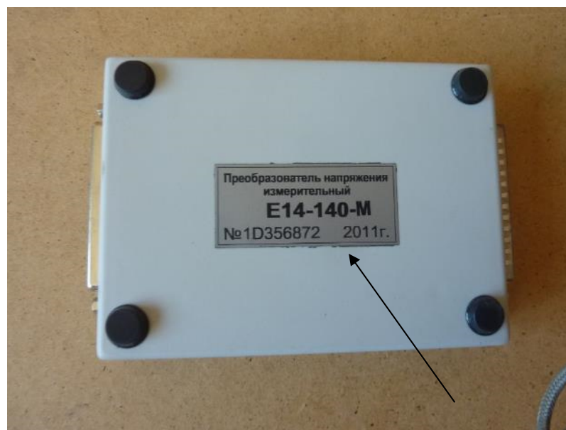
Рисунок 7 – Внешний вид АЦП E14-140 L-Card (вид снизу) и место нанесения его заводского номера и года изготовления
